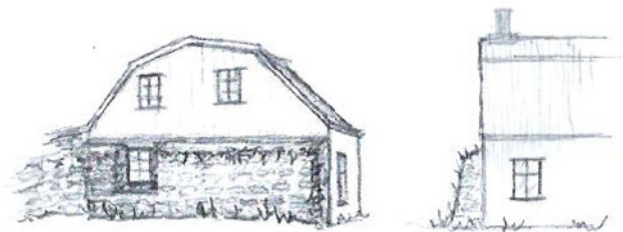
Teikning 2014 e. Hörð Kristjánsson sem sýnir torf- og grjóthleðslu upp að húsvegg
