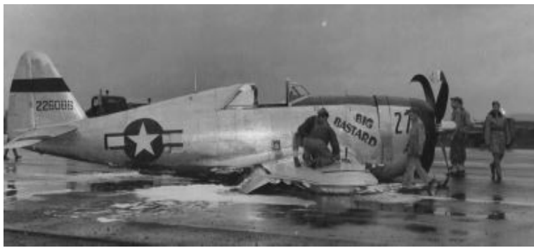
Flugvélin Big Bastard á maganum eftir magalendinguna. Flugvélin var af gerðinni P-47D Thunderbolt. Mynd af vefnum stríðsminjar.is
